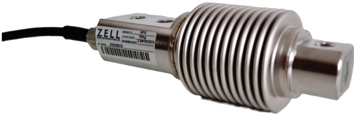
Celda de carga tipo monocelda de acero inoxidable diseñada con estructura de viga en voladizo que permite soportar cargas en ambos sentidos, tensión y compresión y extras torsionales, herméticamente sellada mediante fuelle. Posee alta resistencia a la fatiga.
