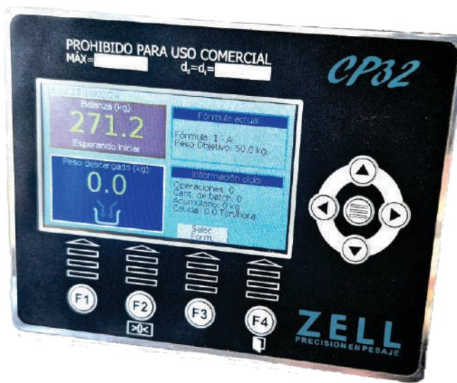
El CP32 V2.09 está diseñado para controlar la dosificación de producto en una balanza de manera automática para poder alcanzar el peso total del big bag. Su avanzado software asegura la máxima precisión y velocidad, manteniendo una interfaz de usuario simple y agradable.
