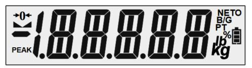
El display es de cristal líquido con backlight blanco, tiene 5 1/2 dígitos de 19mm y varios íconos indicadores. El rango de indicación posible es de 199999 a -199999. Es de fácil lectura en todas las condiciones de iluminación, tanto en la oscuridad como a plena luz del sol.
