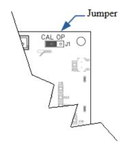
Para uso en aplicaciones donde se desee resguardar el acceso al menú de configuración y calibración, el Jumper 'CAL-OP' debe estar en la posición 'OP'.
