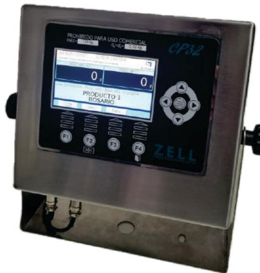
El CP32 V0.05 está diseñado para utilizar junto a una impresora y realizar el etiquetado de productos. Adicionalmente, se crea una tabla de registro, donde se guardan todas las pesadas realizadas. Cuenta con totalizador por producto y destino. Permite además comparar el valor de peso con límites preestablecidos.
