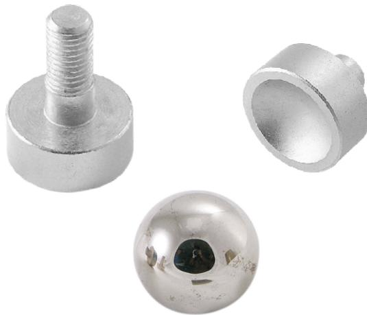
Kit esfera y porta esfera, proporciona una mejora en el estado de carga de la celda, independizando a esta de esfuerzos laterales, generando un incremento de confiabilidad en el sistema. Construidas en acero al carbono con tratamiento superficial de niquelado.
