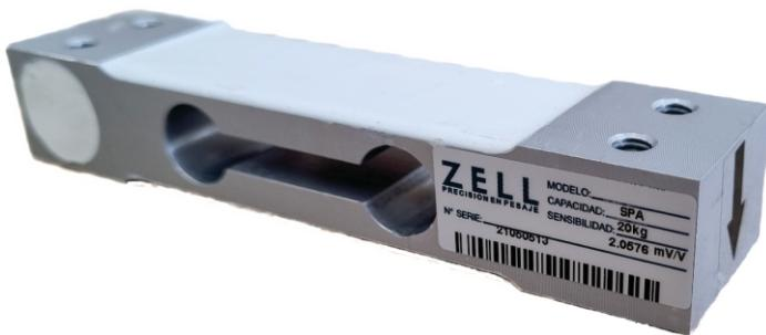
Monocelda de aluminio con tratamiento de anodizado, diseñada con estructura de viga en voladizo. Acepta cargas torsionales. Su diseño y ajuste de esquinas durante su fabricación, garantizan una excelente excentricidad. Apta para aplicar con receptores de cargas de hasta 350 x 350 mm.
